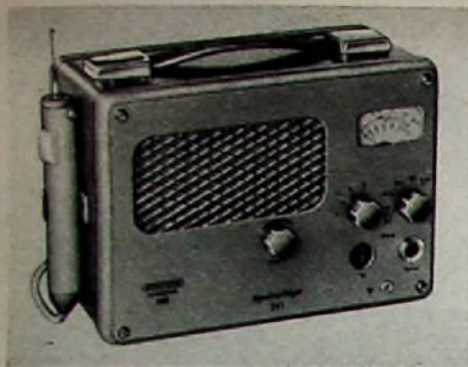
Bild 2. Signalverfolger „SV 1“; der Tastkopf „UK 1“ ist zum Transport an der linken Seite des Gerätes mit einer Klammer befestigt (Grundig)
