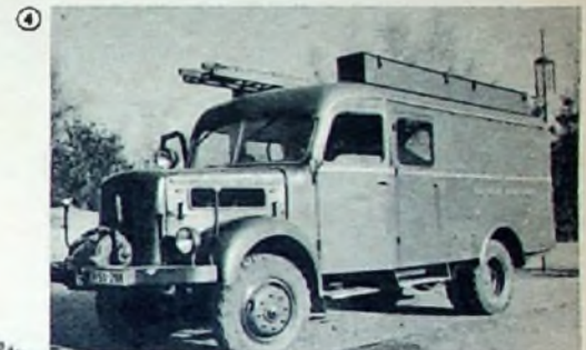
Bild 4. Geländegängiger Entstörungskraftwagen mit UKW-Funksprecheinrichtung und ausfahrbarer Spezialantenne
