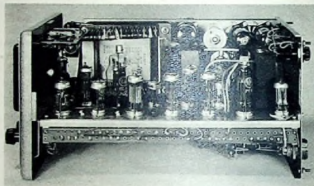
Bild 3. Innenansicht des Philips-Stroboskops „PR 9104“
