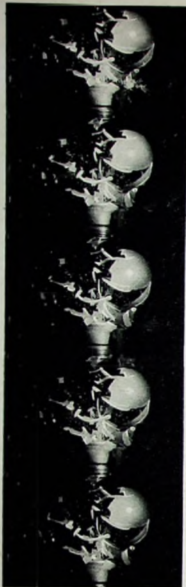
Bild 14. Zerschneiden eines Stahldrahtes durch ein Luftgewehrprojektil mit v_0 \approx 125 m/s; Aufnahmefrequenz etwa 10 kHz
