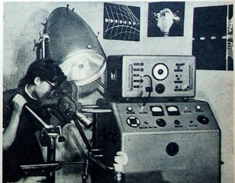
Bild 13. „Strobokin“-Anlage der Firma Dr.-Ing. Frank Fründel GmbH, Hamburg-Rissen, mit einer „high speed“-Kamera
