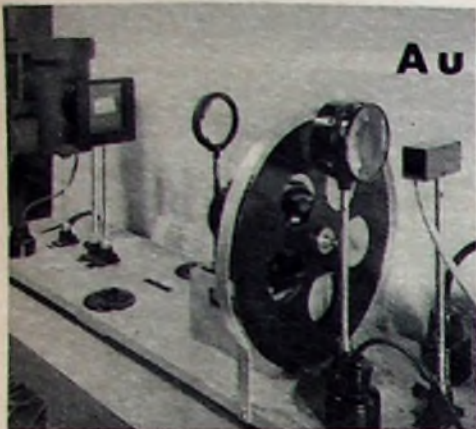
Mit dem Demonstrationsmodell eines Nipkowscheiben-senders (1931-32) wird ein Diapositiv punktförmig abgetastet, und die Helligkeitswerte werden von einer Photozelle in proportionale Stromwerte umgewandelt
