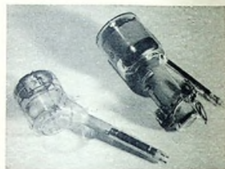
Die elektronische Abtastung erfolgt heute vielfach mit Ikonoskopen; links ein Ikonoskop von W. Heimann (1939), rechts ein Super-Ikonoskop mit Riesekalode der Fernseh GmbH aus dem Jahre 1952
