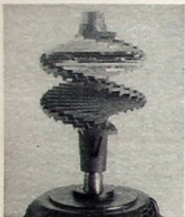
Jeder Zeile des Bildes ist bei dieser Spiegelschraube (1932) zur Bildabtastung (90 Zeilen) eine gegen die vorhergehende versetzte Spiegellamelle zugeordnet
