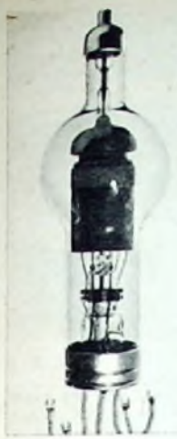
Hochspannungs-Hochleistungsthyatron TQ 8 für 16 kV Sperrspannung und 25 A Dauerstrom (BBC)
