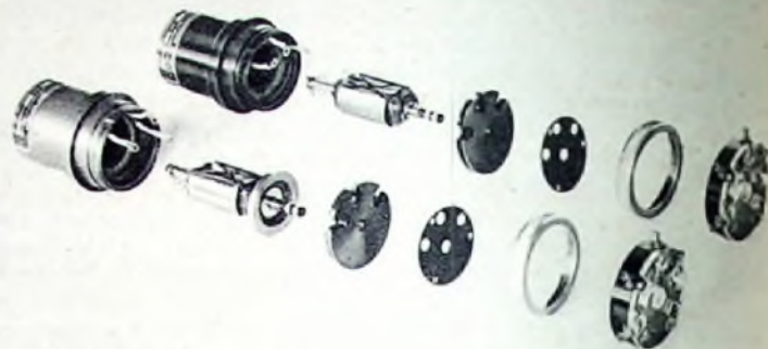
Bild 12. Einzelteile eines Synchros
