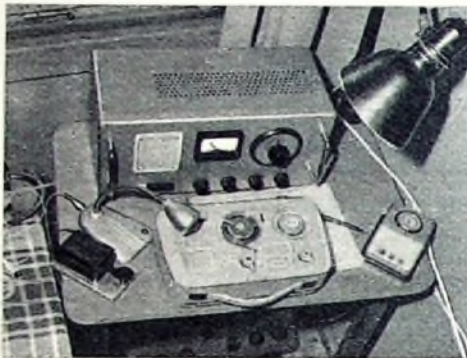
144-MHz-Antennenanlage (10-Element-Yagi von Fuba mit Ruß-Rotor) von DL 3 VD während des Europäischen UKW-Contests auf dem 2224 m hohen Nebelhorn in den Allgäuer Alpen. Links: Blick in die Arbeitsecke des Stationsraumes von DL 3 VD auf dem Nebelhorngipfel; im Hintergrund der UKW-Dreifach-Super, davor das Tonbandgerät „TK 1 Luxus“ (Grundig) mit Stationsmikrofon, rechts davon das Fernsteuergerät für den Ruß-Antennenrotor. (Aufnahmen: Dielenbach)
