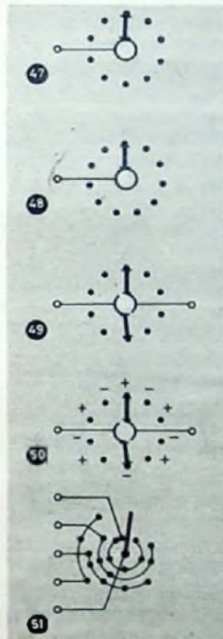
Bild 47. Dekadenschalter mit 1 x 10 Stellungen
