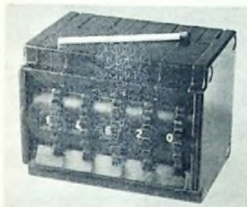
Bild 46. Dekadenschalter für fünfstellige Zahlenwerte
