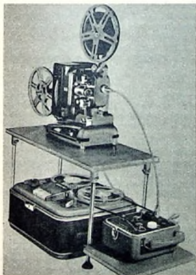
Bild 3. Der Tonkoppler „Synchronomat M 8“ von Paillard-Bolex arbeitet, wie das Schema zeigt, nach einem elektromechanischen Übertragungsprinzip
