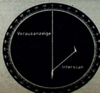
Praktische Anwendung von „Interscan“ zur Ermittlung von Entfernung und Peilung eines Zieles; rechts in Verbindung mit dem üblichen variablen Entfernungsmesskreis
