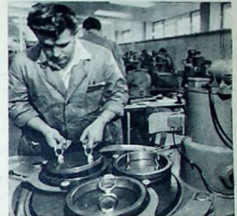
Bild 2. Blick in einen Arbeitsaal mit Läpp-Maschinen zum Planschleifen der Germanium-Scheibchen
