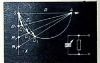
Bild 8. Parallelschaltung von C und R bei veränderlichem C und konstantem f oder bei veränderlichem f und konstantem C
