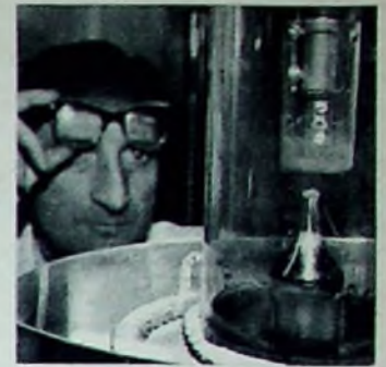
Bild 1. Teil einer Ziehapparatur für Germanium-Einkristalle. Durch den Glasschutzylinder blickt man in die Germaniumschmelze, aus der mittels eines Impfkristalls der Germanium-Einkristall-Stab gezogen wird
