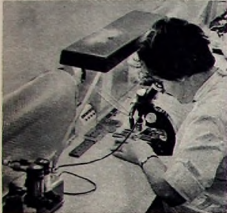
Bild 5. Beschicken von Legierungsformen mit Germaniumplättchen und Indiumkügelchen
