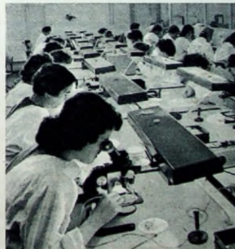
Bild 3. Optische Kontrolle der Kristallplättchen unter dem Binokular-Mikroskop
