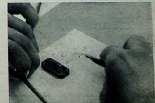
Bild 3. Optische Kontrolle der Kristallplättchen unter dem Binokular-Mikroskop
