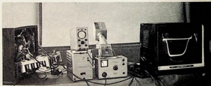
Unter Einsatz modernster Meßeinrichtungen — hier einer Industrie-Fernseh-anlage — werden schwierig sichtbar zu machende Meßvorgänge und Oszillogramme stark vergrößert auf dem Bildschirm eines Fernsehempfängers dargestellt
