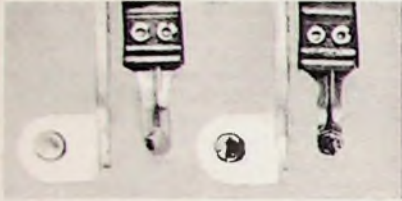
Bild 4. Zustand der Unterbrecherkontakte nach 44000 Meilen (etwa 70800 km); linkes Paar Transistor-Betrieb, rechtes Paar Direktunterbrechung
