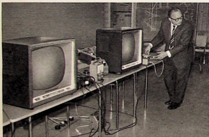
Unter Einsatz modernster Meßeinrichtungen — hier einer Industrie-Fernseh-anlage — werden schwierig sichtbar zu machende Meßvorgänge und Oszillogramme stark vergrößert auf dem Bildschirm eines Fernsehempfängers dargestellt
