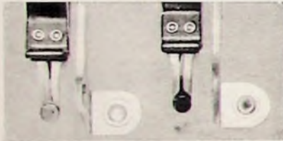
Bild 5. Zustand der Unterbrecherkontakte nach 20 Öffnungen bei einer Temperatur von -29^{\circ}\text{C}
