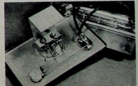
Bild 8. Die Verdrahtung des Stehwellenmessers muß stabil und kapazitätsarm ausgeführt werden
