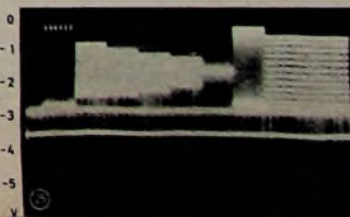
Bild 25 (unten). BAS-Signal mit Störungen am Gitter 3 von R6 1a
