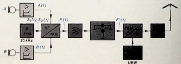
Bild 4. PAM-Stereo-System. Blockschema des Senders
