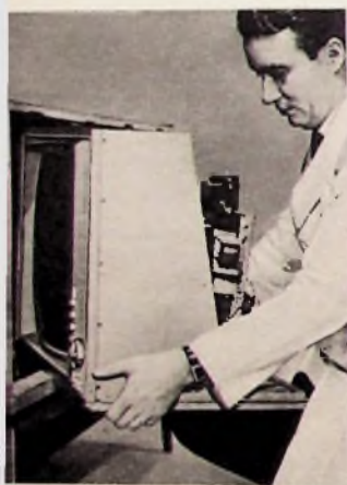
Der in Führungsschienen laufende Fernsehgerät „Terzola VI“ kann als Einheit ausgebaut ohne daß dadurch die Funktion des Rundfunk- und Phonoteils beeinträchtigt wird
