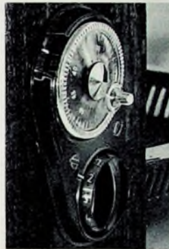
Bild 9 Doppelknopfschale mit UHF- und VHF-Kanalwähler (Nordmende)
