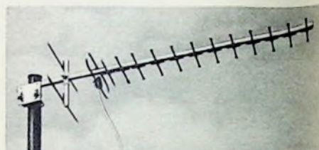
Bild 17. Super-Breitbandantenne „FW 115 R/14-53“ für die Bänder IV und V der Deutschen Elektronik (Gewinn etwa 9,5 dB, Vor-Rückverhältnis etwa 20 dB)
