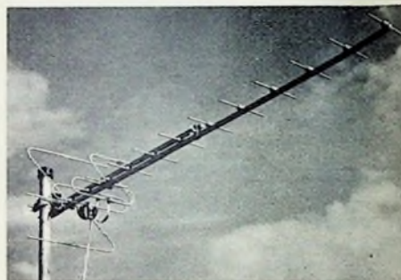
Bild 18. Super-Breitbandantenne „Dezi-Dura“ von Kathrein (Gewinn 8...11 dB, Vor-Rückverhältnis 20...26 dB, horizontaler Öffnungswinkel 27...52°)
