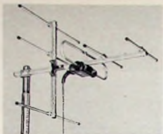
Bild 15. Band-IV-Breitbandantenne „934“ von Wisi (Gewinn etwa 6 dB, Vor-Rückverhältnis etwa 22 dB, horizontaler Öffnungswinkel etwa 62°)
