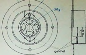
Bild 25 (oben und links). Zweite Ausführung des Ersatzsockels
