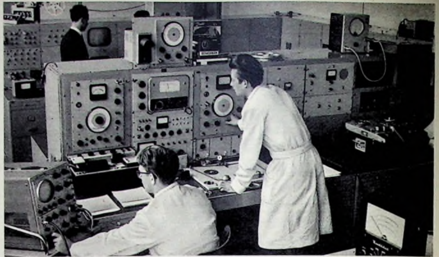
Bild 8. Vollautomatische Meßanlage für die Prüfung von Magnetbändern. Die Bandgeschwindigkeit kann auf 4,75/9,5/19/38/76 cm/s eingestellt werden. Mit dem Papierstreifenreiber (links im Bild) lassen sich die Gleichmäßigkeitskurven (Modulationsrauschen) aufnehmen. Für die Aufnahme der Frequenzcharakteristik kann die Einstellung des Papiervorschubs mit der Frequenzeinstellachse des Tongenerators gekoppelt werden; ebenso ist es möglich, auch für die Aufnahme der U_A - I_{HP} -Kurve den Papiervorschub mit der I_{HP} -Einstellung zu koppeln
