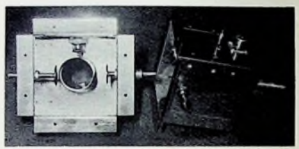
Bild 35. Anoden-Topfkreis der vereinfachten Stufe
