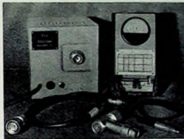
Bild 55. Einzelteile der HF-Leistungsmeßanlage: Absorber „S100/30“ (Rohde & Schwarz), Diodenvoltmeter „Rel 3 U 17c“ (Siemens), HF-Spannungsteiler „3 U 911a“ (Siemens), Koaxialkabel mit Z = 60 Ohm
