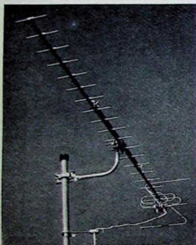
Die UHF-Super-Breitbandantenne „DFA 1 LM 51“ von fuba läßt sich sehr gut zusammenklappen
