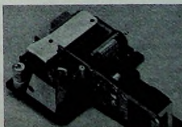
Chassis des Senders. Rechts: Transistor-Gleichspannungswandler; links: Oszillatortspule; oben: Röhre, Anodenkreis-spule und Antennen-Verlängerungsspule
