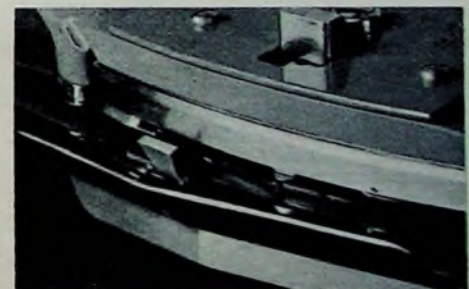
Universal-Studio-Kopfträger „206“ mit Band-Schneidvorrichtung (Vollmer); oben: bei Aufnahme und Wiedergabe, unten: Beginn des Bandschnitts nach Betätigung der Schneidlaste
