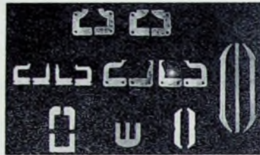
Bild 7 (links). Massivteile aus weichmagnetischen Werkstoffen. Bild 8 (rechts). Hochpermeable Kernbleche für Magnetonköpfe
