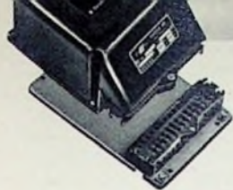
Bild 1. Elektronisches Zeitrelais „ZS 18“ (Elesla) in Stecksatzausführung, bestückt mit Kaltkathodenpentode ER 32 (Elesla)
