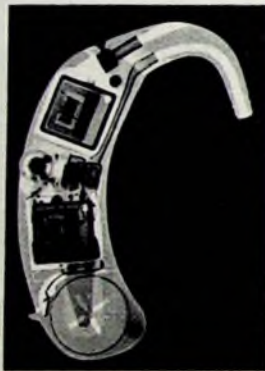
Röntgenaufnahme des neuen elektronischen Hörgerätes in etwa natürlicher Größe
