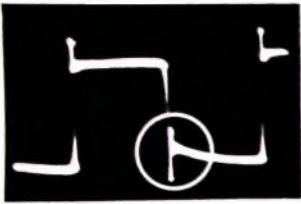
Bild 7 Oszillogramm einer Impulsspannung (Rechteck)
