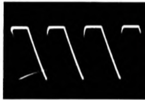
Bild 6. Sägezahnspannung an der Anode von Röhre 5 im Triggerbetrieb: die waagerechten Abschnitte stellen die Wartezeit dar, an die sich der Vorlauf anschließt
