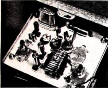
Bild 4. Aufbau einzelner Bauteile des HF-Bausteins
