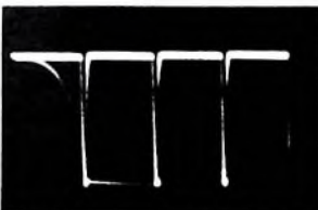
Bild 5. Dunkelastimpulse am Kondensator C 33
