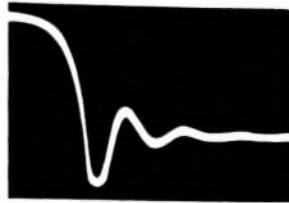
Bild 7 Oszillogramm einer Impulsspannung (Rechteck)
