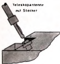
Ansicht der unter einem Winkel von 45° eingebauten Antennenbuchse
