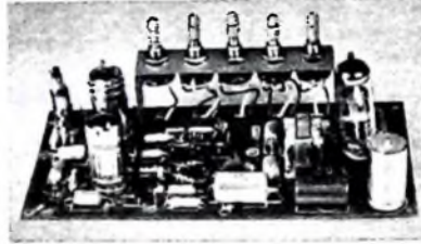
Links: AM/FM-ZF-Baueinheit mit Transistoren; rechts: Baueinheit für Impulsablenkung sowie Zeilen- und Bildablenkstufen mit gedruckter Schaltung (Orega)
