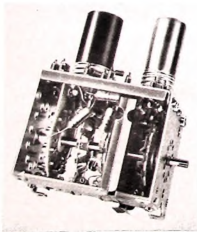
Bild 6. Ansicht des fertig verdrahteten Schaltertuners
