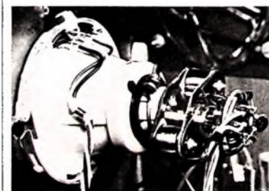
Spuleneinheit des elektromagnetischen Zeilenunterdrückungssystems für die Geräte der Standardklasse. Links: die Spuleneinheit auf dem Bildröhrenhals
