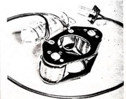
Spuleneinheit des elektromagnetischen Zeilenunterdrückungssystems für die Geräte der Standardklasse. Links: die Spuleneinheit auf dem Bildröhrenhals
