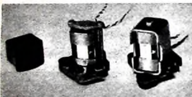
Bild 3. Ansicht der neuen Halbspur-Stereo-Köpfe; von links nach rechts: Löschkopf, Sprechkopf, Hörkopf
