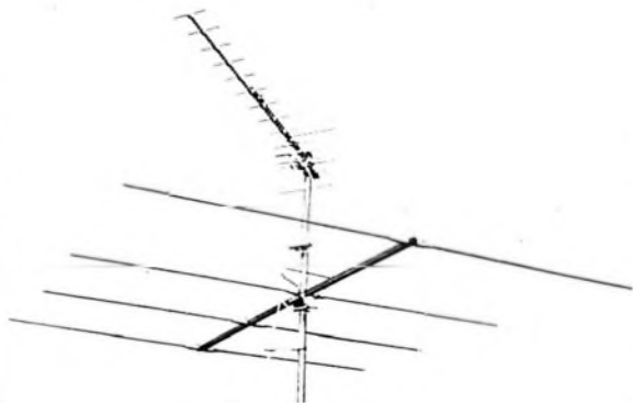
Band I-Antenne von Kathrein in klappbarer Ausführung mit gestrecktem Dipol mit darüber montierter UHF-Antenne. Die Niederführungen beider Antennen sind mit einer Mehrfachweiche zusammengeschaltet.
