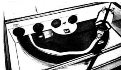
Modell zur Erläuterung der Arbeitsweise eines Dual-Stereo-Kristallsystems
