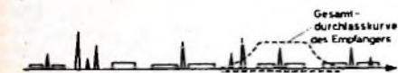
Bild 2. Schematische Darstellung des Abstimmvorgangs für einen weniger trennscharfen Empfänger mit einer Durchlaßkurve geringer Flankensteilheit
