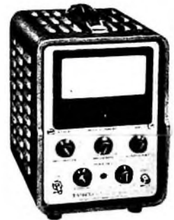
Bild 6: Mikrowellen-Leistungsmesser .650C (PRD) für 0,1...100 mW ohne äußere Dämpfungsglieder (Genauigkeit \pm 3\% ); ein Schutzrelais sichert den Bolometerfühler gegen Überlast und Verbrennen; Vorspannung für 0...40 mA vorhanden; jedes beliebige Bolometer ist verwendbar.
