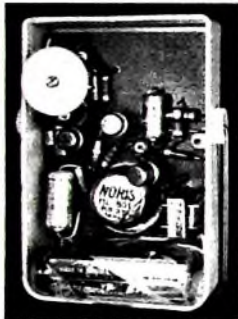
Bild 4 (unten): Innenansicht des betriebsfertigen Verstärkers (Gehäuserückseite abgenommen)
