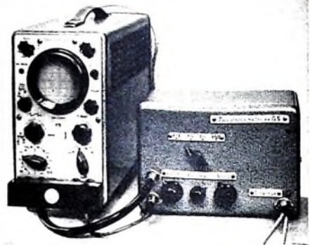
Bild 6. Zwei Strahlenschalter nach Bild 2, mit dem Grundig-Oszillografen „G 5“ über eine 6polige Steckerleiste mit zusätzlichem Druckknopfschalter zusammengeschaltet
