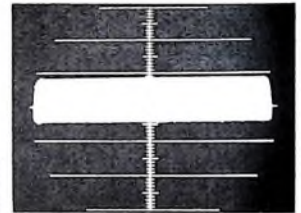
Bild 31 Oszillogramm des Vormagnetisierungsstroms, am Serienwiderstand des Sprechkopfs aufgenommen.
