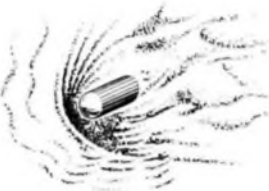
Bild 25. Plasmaschild einer mit Überschallgeschwindigkeit in die Erdatmosphäre ein tretenden Raumkapsel
