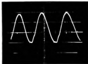
Bild 30 Messung wie Bild 29, jedoch mit Tastkopfabschwächer 1:10.
