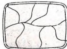
Bild 2. Sprungbild des Schirms nach gewaltsamer Zerstörung der Röhre.
