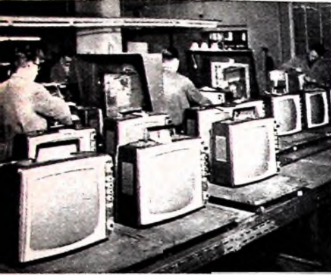
Einstellung der Bild- und Zeilenamplitude sowie der Bildgeometrie bei Fernsehempfängern vom Typ „Fernseh-Boy“ im Einbaubild für Fernsehempfänger
