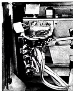
Steckfassung für den Anschluß eines Stereo-Konverters in Blaupunkt-Rundfunkempfängern
