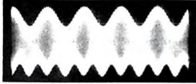
Bild 1 Stereo-Gesamtsignal nach Zulugung des 38-kHz-Hilfsträgers
