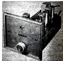
Auf drei fest eingestellte Sender umschaltbarer UKW-Tuner (Rogers)
