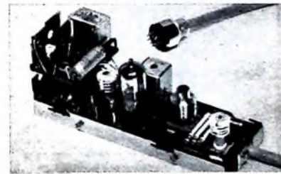
Stereo-Decoder „V“ mit Umschaltautomatik (links oben auf besonderer Schaltplatte) ohne Gehäuse
