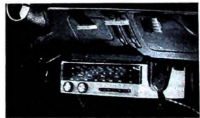
Bild 3. Beim Einschleiben in die Autohalterung muß der Bügel nicht abgenommen werden; er dient vielmehr gleichzeitig als Verriegelung des Empfängers.
