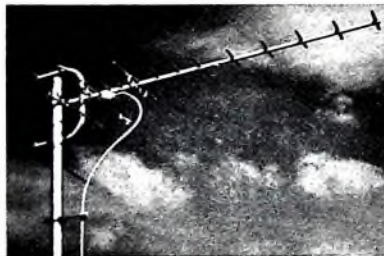
Kombinationsantenne „FSA 1 U 14“ (oben) von fuba, die neuartige Form des für den VHF- und UHF-Bereich gemeinsamen Dipols ist gut aus dem rechten Bild (Teilschnitt der Antenne „FSA 1 U 8“) erkennbar
