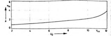
Bild 6. Klirrfaktor k in Abhängigkeit vom Eingangspegel U_E (linker Kanal mit 1 kHz moduliert, U_P = 0,1 U_E )
