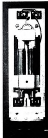
Blick in das geöffnete Antennen-Umschaltrelais
