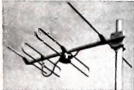
Spezialantenne (Testantenne) „SP 322“ von fuba für den Fernsehbereich III
