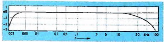
Bild 7 Leistungsbandbreite des „VS-71“ für 40 W Ausgangsleistung ( k = 0.5\% )
