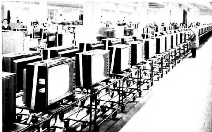
Das 65 m lange Dauerprüfband, das jeder Grundig-Fernsehempfänger durchlaufen muß, bevor er zur Endkontrolle gelangt
