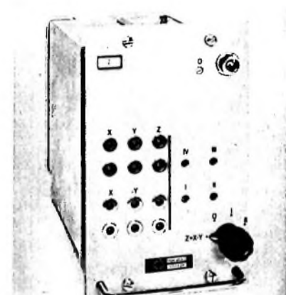
Bild 19. Technische Ausführung eines Parabelmultiplikators mit eingebautem Verstärker nach Bild 18. In den Schalterstellungen 0, 1, ... können der Verstärker bzw. die Parabeläste einjustiert werden
