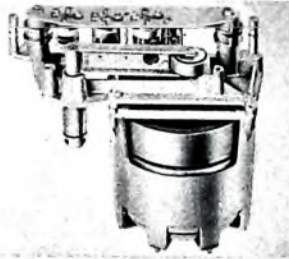
Bandlaufaggregat des „Revox G 36“ mit Ringköpfen und Capstanantrieb
