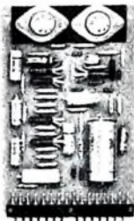
Bild 31. Montageeinheit zur Aufnahme von 15 Rechenverstärkern des Tischrechners „RAT 700“
