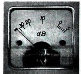
Bild 6. Das für den Aussteuerungsmesser verwendete Meßgerät
