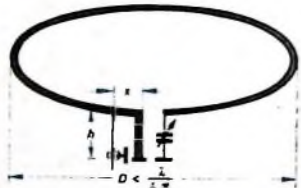
Bild 2 Aufbau der DDDR-Antenne ( h Höhe über dem Boden oder Gegengewicht, x Abstand des Einspeisungspunkts vom geraden Ringende)
