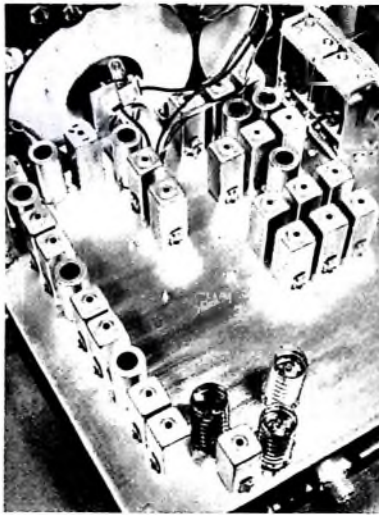
Bild 8. Teilansicht mit Drehkondensator und Doppelskala an der Frontseite
