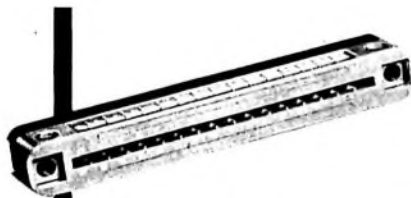
T 2780 Federleiste für gedruckte Schaltungen Breite 17 u. 34 polig Nennstrom 5 A Nennspannung 500 V ~ Präzise, kräftige Federleiste für die Steckbe- wechung von gedruckten Schaltungen in der ge- samten Elektronik u. Impulstechnik.
