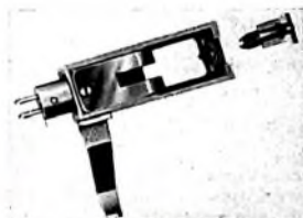
Bild 3 Abtaster „AG 3407“ mit herausgenommenem Nadelträger
