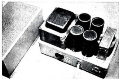
Bild 12. Der Wechselstrom-Netzteil macht bei abgenommener Haube einen sehr kompakten Eindruck
