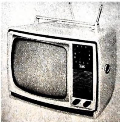
„Featherlight“, ein tragbares Fernsehgerät (Gewicht 7,25kg) für Netzbetrieb mit 28-cm-Bildröhre (Kolster-Brandes)
