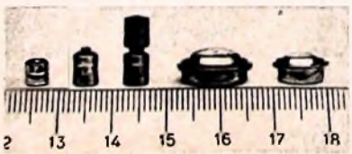
Bild 2. Gasdichte VARTA-DEAC-Akkumulatoren: von links nach rechts: Kleinstakkumulatoren 4,5 und 6,5 mAh, zweizellige Kleinstbatterie 6 mAh/2,5 V, Knopfzellen „50 DK“ (50 mAh) und „20 DK“ (20 mAh)
