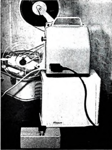
Bild 29. Anordnung von Synchronisator, Projektor und Tonbandgerät bei der Filmvertonung
