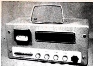
Bild 1. Ansicht des 2-m-Dreifachsupers mit „Sekundo“-Lautsprecher und (rechts) Maßskizze der Frontplatte
