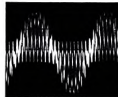
Bild 23 Stark übersteuertes Multiplex-Signal bei zu großem Hub
