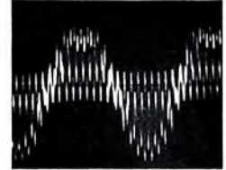
Bild 24 Schwach übersteuertes Multiplex-Signal, das außerdem infolge leichter Oszillatorverstellung unsymmetrisch (obere Amplitude) verzerrt erscheint
