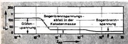
Bild 1. Strom-Spannungs-Kennlinie einer „BT-Arcotron“-Röhre mit Glüh- und Bogenspannung; U_0 Brennspannung, I_{HA} Hilfsanodenstrom
