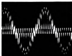
Bild 27. Bei dem während der Messungen zweckmäßigerweise verringerten Hub für die NF bleibt der Pilotanteil jedoch unverändert 10% (das heißt 7,5 kHz) des Maximalhubes 75 kHz.
