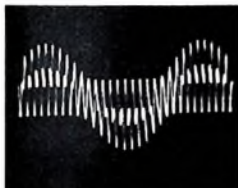
Bild 27. Bei dem während der Messungen zweckmäßigerweise verringerten Hub für die NF bleibt der Pilotanteil jedoch unverändert 10% (das heißt 7,5 kHz) des Maximalhubes 75 kHz.
