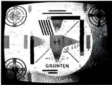
Bild 2 Störungen auf dem Bildschirm, hervorgerufen durch Zündkerzenfunken
