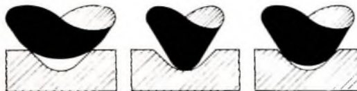
Bild 2. Die verschiedenen Lagen der Abtastnadel in der Schallplattenrille
