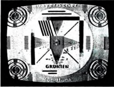
Bild 1 „Geisterbild“ infolge Reflexion des Sendestrahls an einem Hindernis
