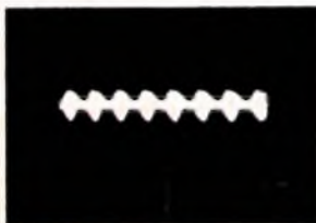
Bild 41. Übersprechoszillogramm wie im Bild 40, in dem man aber optisch sofort „interpolieren“ kann; die ständige NF beträgt amplitudenmäßig etwa die Hälfte (6 dB) der Gesamtschwingung
