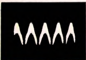
Bild 41. Übersprechoszillogramm wie im Bild 40, in dem man aber optisch sofort „interpolieren“ kann; die ständige NF beträgt amplitudenmäßig etwa die Hälfte (6 dB) der Gesamtschwingung
