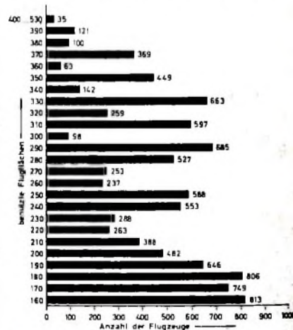
Bild 3. Nach Flugflächen geordnete Verkehrsdichte. Die „Flugfläche“ ist auf eine gleiche, genau definierte Grundeinstellung der barometrischen Höhenmesser oder Flugzeuge bezogen (1013,2 mb für die Höhe NN); ihre Bezeichnung erfolgt in ft/100. Zwischen zwei Flugflächen (zum Beispiel 200 und 210) besteht demnach ein Höhenunterschied vom Hundertfachen der Differenz der Flugflächen, im obigen Beispiel also von 10 \cdot 100 = 1000 ft (rund 300 m)
