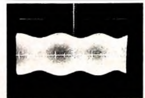
Bild 46. Hilfsträgeroszillogramm wie im Bild 45, jedoch nach weiterem Vergrößern der X- und Y-Amplitude
