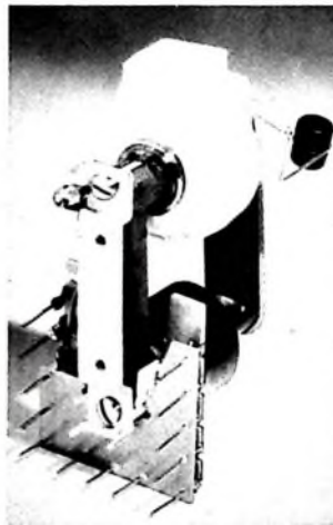
Bild 9 (oben). Horizontal-Ablenktransformator „AT 2042“
