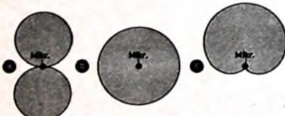
Bild 6. Richtcharakteristiken von Mikrofonen: achterförmig (a), kugelförmig (b), nierenförmig (c)
