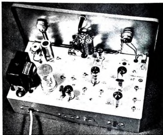
Bild 3 Außenansicht mit Anordnung der Bedienelemente auf der Frontplatte
