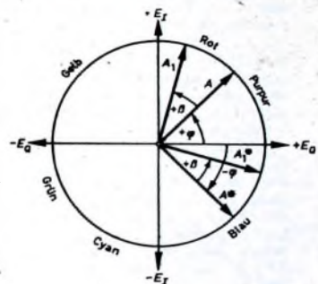
Bild 4. Vektor A^* , der sich vom Vektor A im Bild 3 nur dadurch unterscheidet, daß er den Phasenwinkel -\varphi hat.
