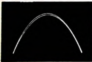
Bild 9 Lissajous-Figur zur Kontrolle der Phasenbeziehungen des 19-kHz-Verstärkers
