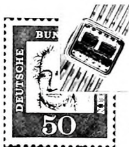
Bild 13. Integrierter Schaltkreis als flat package im Größenvergleich zu einer Briefmarke (Telefunken)
