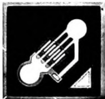
Bild 15. Struktur des Silizium-Planar-Transistors BF 168 von Valvo
