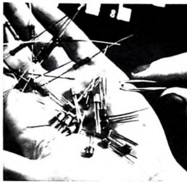
Bild 12. Bauelement für Datenverarbeitungssystem „4004“ von Siemens in Festkörpertechnik (zwischen der Pinzette) und Bauteile, die hierfür normalerweise benötigt werden (15 Transistoren, 13 Widerstände)
